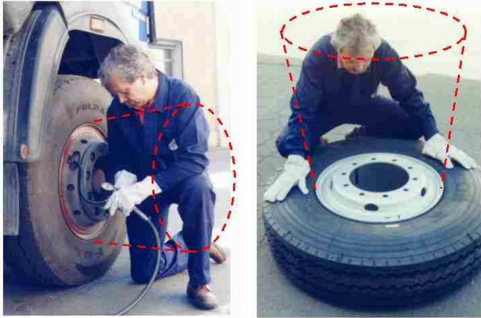
Bild Nr. 6 – Gefahrenzone, die bei der Handhabung von Rädern mit mehrteiligen Felgen zu vermeiden ist
