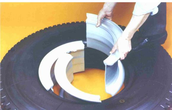
Il terzo settore è collegato a quello con la valvola
