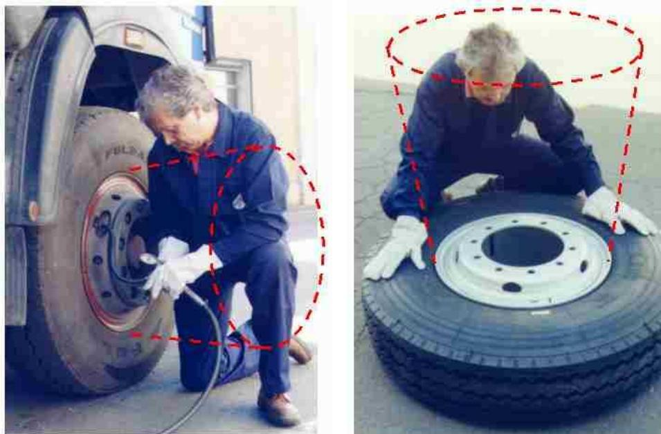
Figura 7 - Esempi di sequenze di serraggio riferite a ruote a disco per veicoli commerciali con fissaggio a 6, 8, 10 colonnette e al sistema di ruota TRILEX®.
